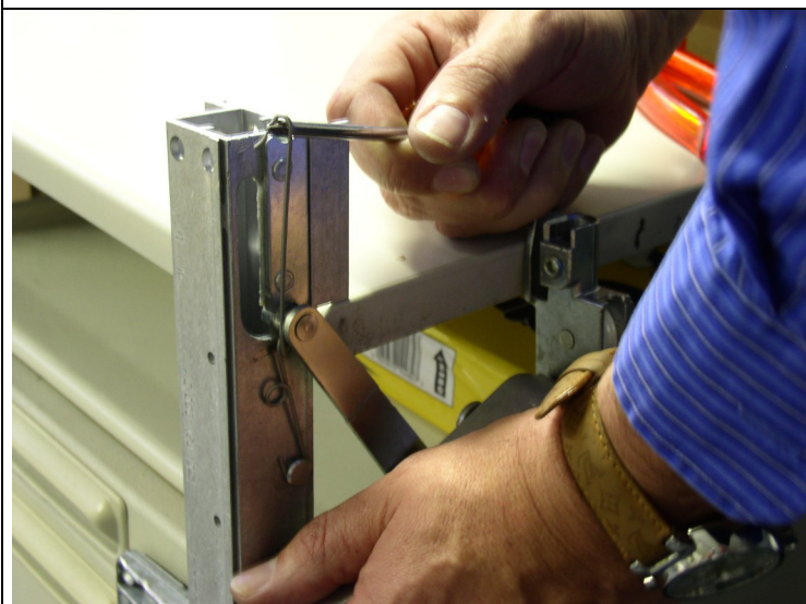
Schraubendreher in Schlaufe stecken - - -
